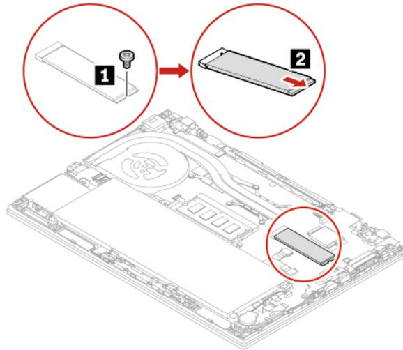
6. Gehen Sie wie folgt vor, um ein neues M.2 Solid-State-Laufwerk zu installieren:
