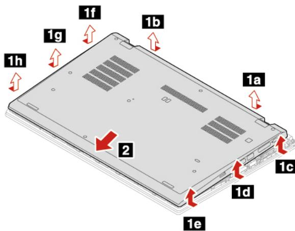
7. Bringen Sie die neue Baugruppe für die untere Abdeckung in aufsteigender alphabetischer Reihenfolge (a bis k) an. Vergewissern Sie sich, dass die Verriegelungen unter der Grundplattenabdeckung sicher sitzen.
