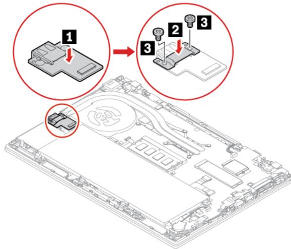
7. Schließen Sie den Anschluss der Platine an.
