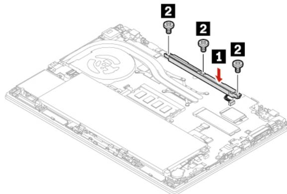
7. Schließen Sie den Anschluss der Lautsprechereinheit an.
