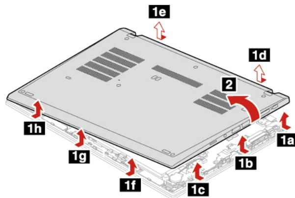
7. Bringen Sie die neue Baugruppe für die untere Abdeckung in aufsteigender alphabetischer Reihenfolge (a bis i) an. Vergewissern Sie sich, dass die Verriegelungen unter der Grundplattenabdeckung sicher sitzen.
