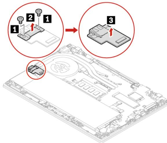
6. Installieren Sie die neue Platine an der entsprechenden Position **1**. Installieren Sie dann die Halterung an der Platine **2** und bringen Sie die Schrauben zur Fixierung der Platine an **3**.
