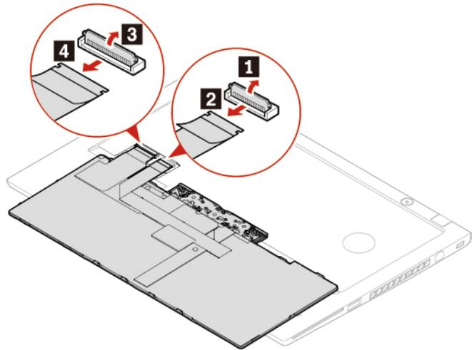
9. Schließen Sie die Anschlüsse an und wenden Sie die Tastatur, wie in der Abbildung dargestellt.
