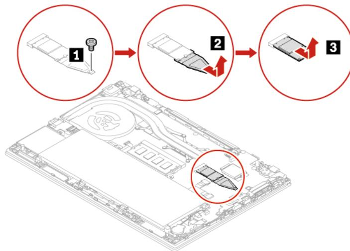
5. Installieren Sie das neue M.2 Solid-State-Laufwerk in der Halterung **1** und setzen Sie das neue M.2 Solid-State-Laufwerk mit der Halterung in den Laufwerksteckplatz ein **2**. Befestigen Sie dann die Halterung mit der Schraube **3**.
