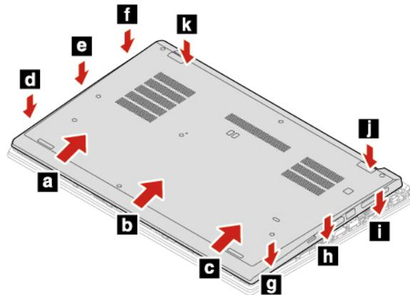
8. Ziehen Sie die Schrauben fest, um die Baugruppe für die untere Abdeckung zu fixieren.
