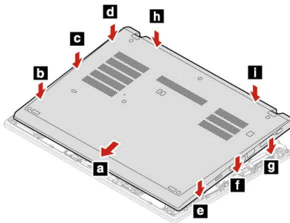
8. Ziehen Sie die Schrauben fest, um die Baugruppe für die untere Abdeckung zu fixieren.
