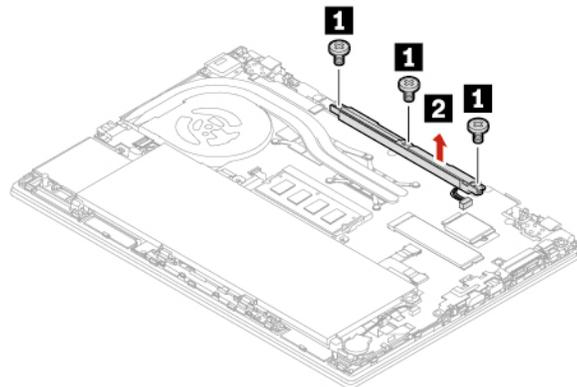
6. Montieren Sie die neue Lautsprechereinheit an der entsprechenden Position **1** und ziehen Sie die Schrauben fest, um die Lautsprechereinheit zu fixieren **2**.
