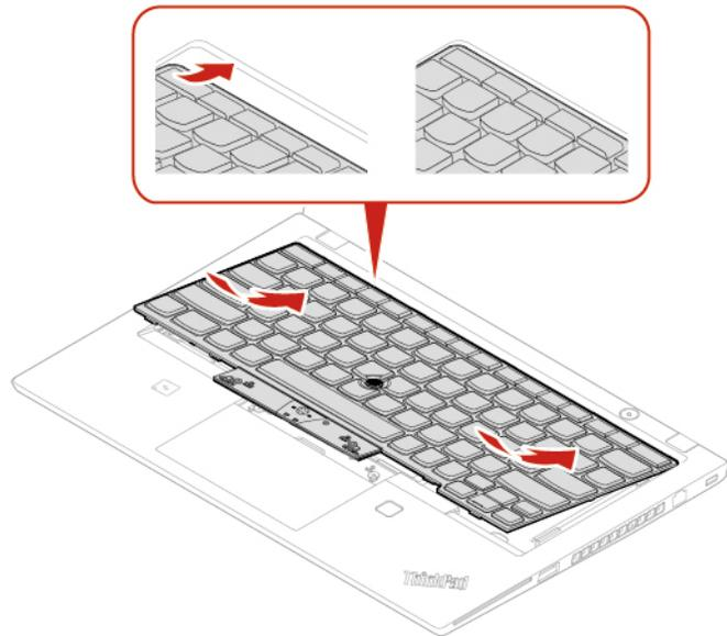
11. Schieben Sie die Tastatur in die durch die Pfeile angegebene Richtung. Vergewissern Sie sich, dass die Verriegelungen unter dem Tastaturrahmen gesichert sind.
